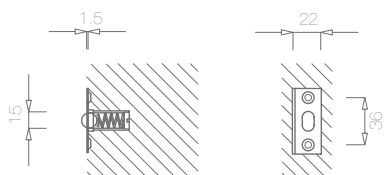
Fecho de esfera Recomendado para janelas de porta Regulação da força da esfera com dois parafusos
